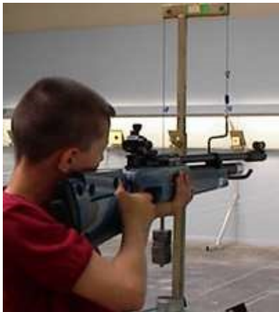
Figura 5 - Suporte fixo com sistema de contrapeso (móvel) e sistema de apoio para pistola ou carabina com gancho em forma de "U".
