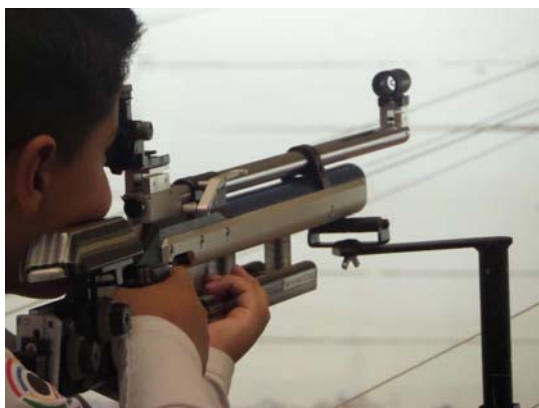
Figura 7 - Suporte fixo para pistola ou carabina, com sistema de apoio das armas em forma redonda, sem mola flexível na sua haste e ajustável em altura. A base de apoio da arma é ajustável num plano de 360°.
