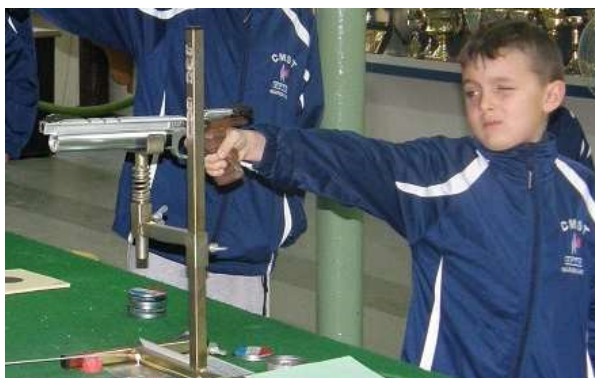
Figura 4 - Suporte fixo regulável em altura com mola flexível e uma base de apoio da pistola ou carabina em forma de "U"
