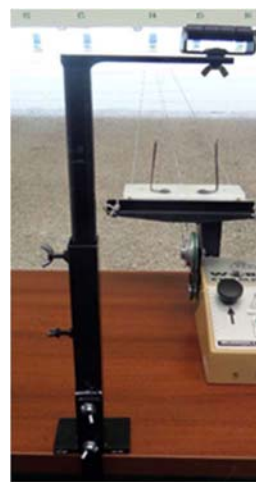
Figura 7 - Suporte fixo para pistola ou carabina, com sistema de apoio das armas em forma redonda, sem mola flexível na sua haste e ajustável em altura. A base de apoio da arma é ajustável num plano de 360°.
